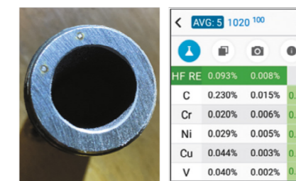
Рис. 3. Анализ Углерода ниппеля трубы diam. 1” s/160 A106 для обслуживания установки HF алкилирования с SciAps Z-902
